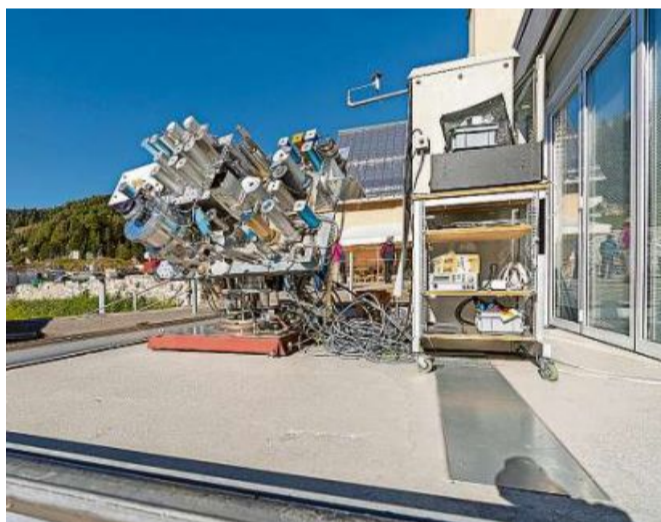
Hightech-Apparatur: Auf dieser Plattform (Bild links) befinden sich die Instrumente der Davoser Weltstandardgruppe, mit denen Sonnenmessgeräte (Bild rechts) kalibriert werden. Pressebilder
