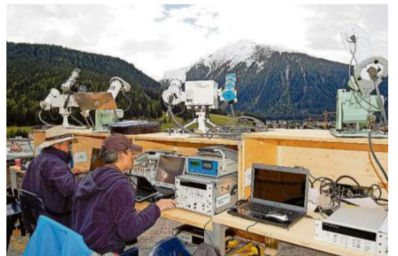
Hightech-Apparatur: Auf dieser Plattform (Bild links) befinden sich die Instrumente der Davoser Weltstandardgruppe, mit denen Sonnenmessgeräte (Bild rechts) kalibriert werden. Pressebilder
