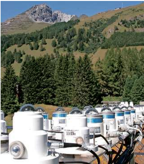
Solare UV-Radiometer auf der Messplattform am Dach des PMOD/WRC während der UV-Kalibrierkampagne im Sommer 2017. Bild: zVg/Gregor Hülsen
