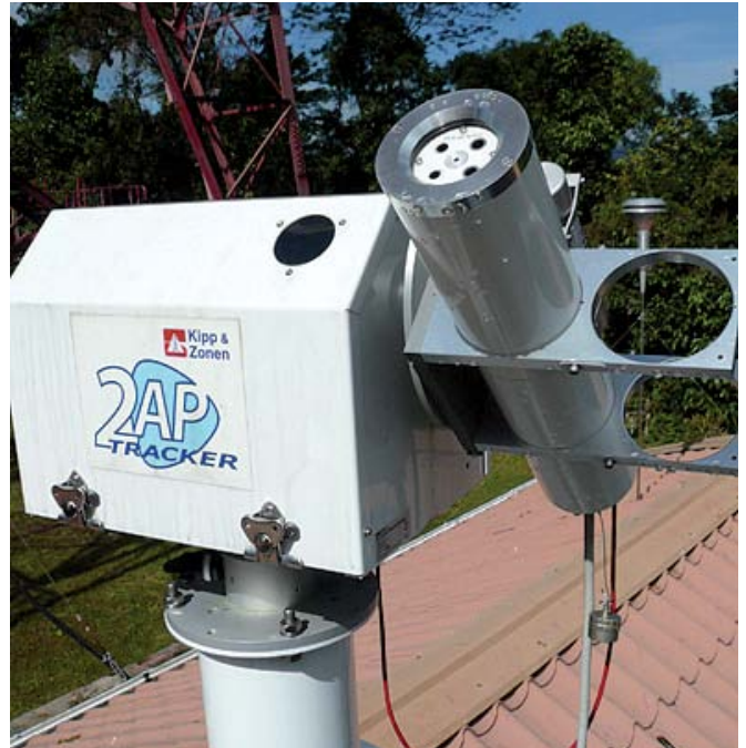
Ein Filterradiometer des Typs PFR das am PMOD/WRC gebaut wurde, montiert auf einer Sonnennachführung der GAW Station Danum Valley im tropischen Regenwald von Borneo, Malaysia.
