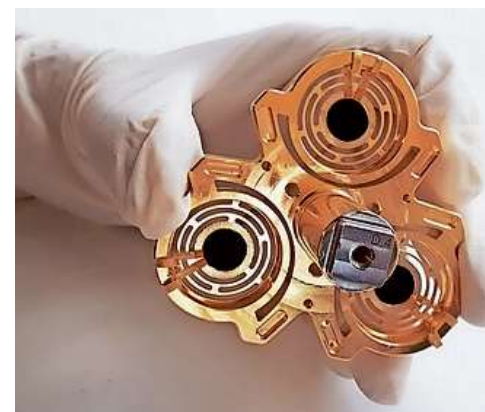
Der Schein trügt: Hinter den drei schwarzen Kreisen des Radiometers, die wie Oberflächen erscheinen, verbergen sich trichterförmige Vertiefungen. Bild: zVg/ D. Heinen
