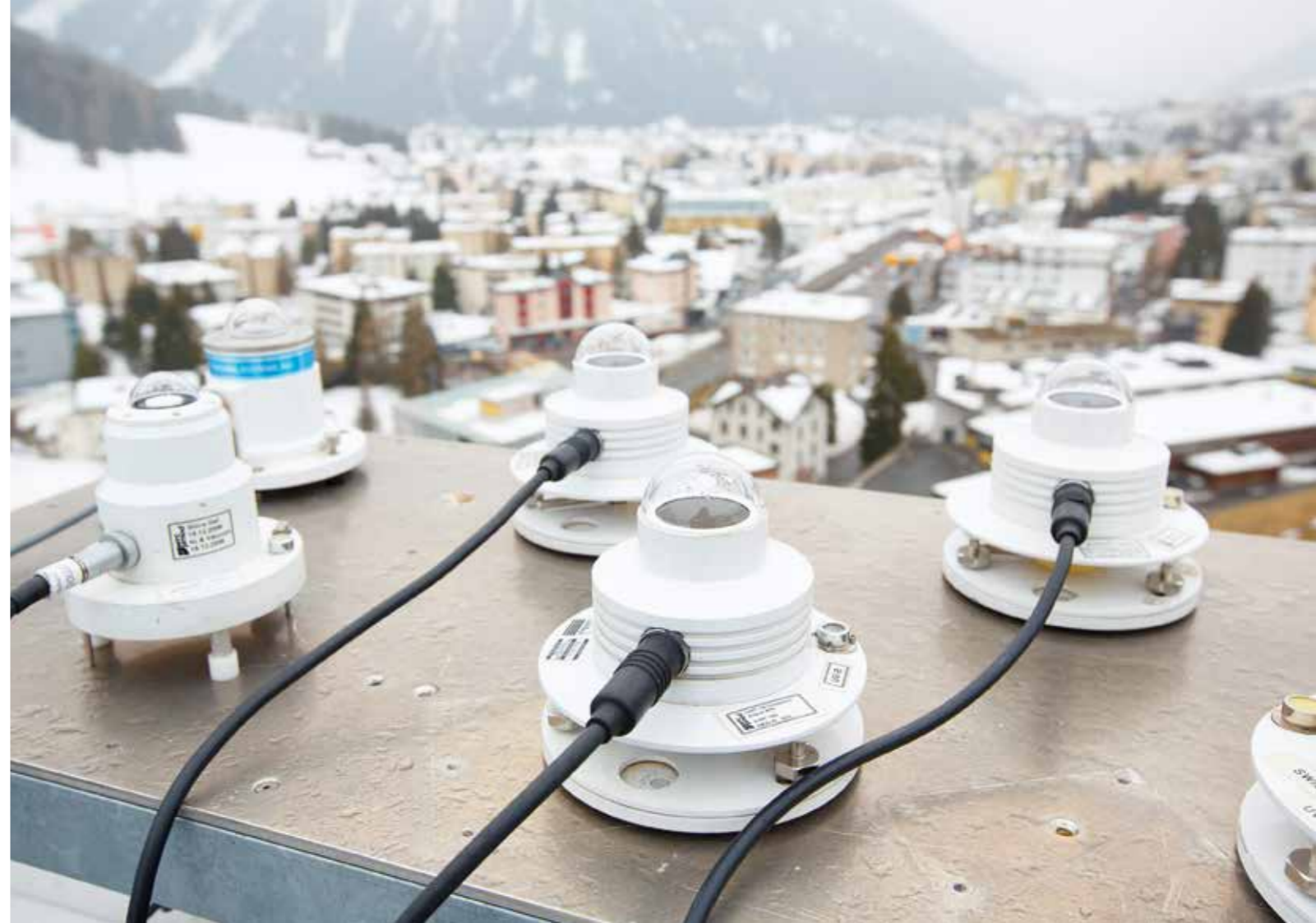
Die Forscher entwickeln und bauen die Instrumente in Davos selber. Eine der zentralen Aufgaben des PMOD/WRC ist neben der Entwicklung die Kalibrierung (ein Messprozess zur Bestimmung der Genauigkeit von Messgeräten) von Geräten zur Sonnen- und zur Ultraviolettstrahlung.
