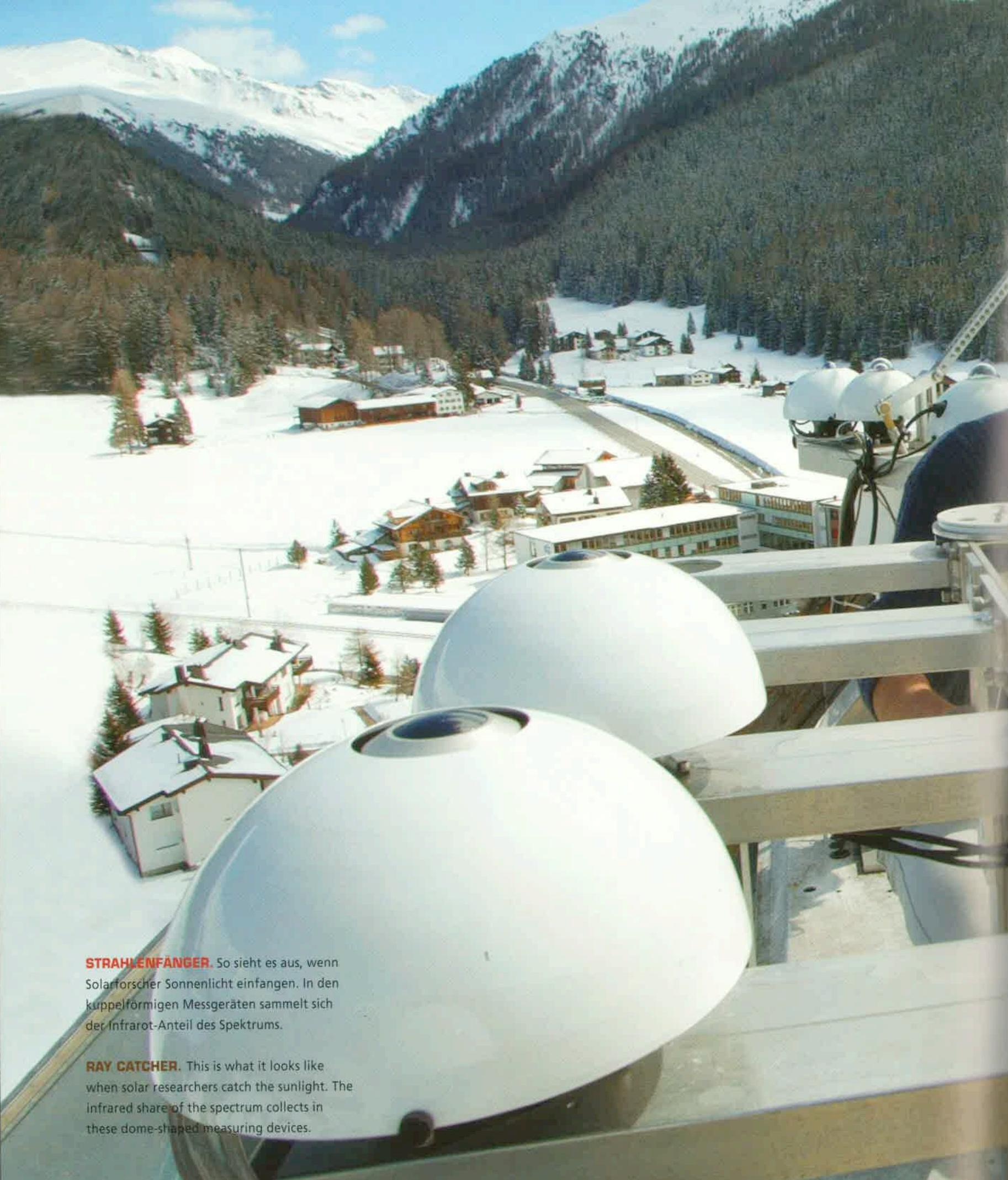
**STRAHLENFÄNGER.** So sieht es aus, wenn Solarforscher Sonnenlicht einfangen. In den kuppelförmigen Messgeräten sammelt sich der Infrarot-Anteil des Spektrums.
