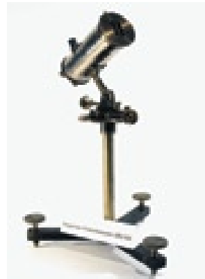
Den Messungen der Silverdisk (links) des Smithsonian Institute, Washington, USA, und des Angström-Pyrheliometers (rechts), Uppsala, Schweden, lagen unterschiedliche Skalen zugrunde
