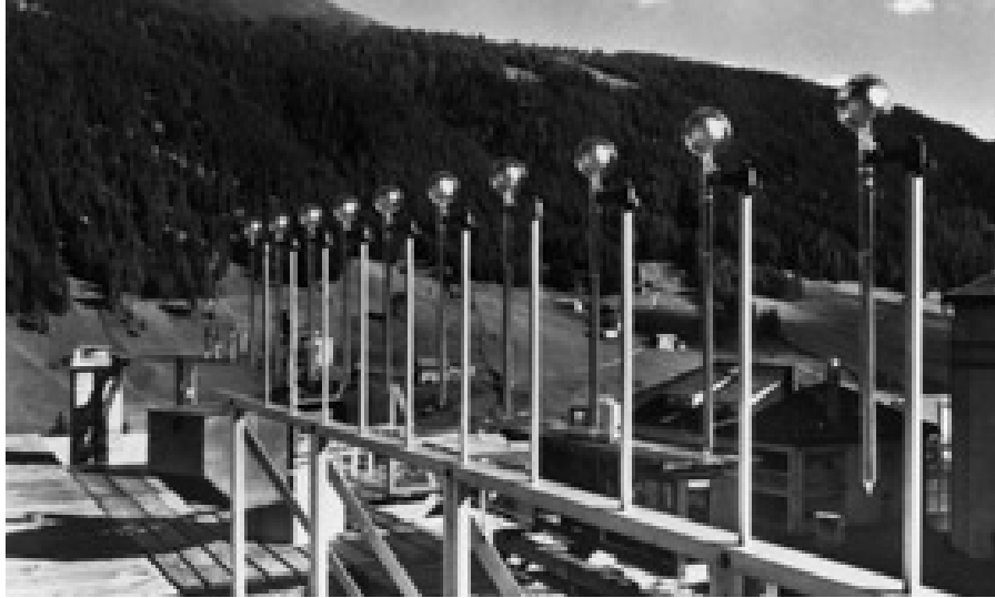
Davoser Modell des Bellani-Kugelpyranometers um 1960
